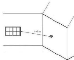
Par rapport à un angle rentrant, zone d'interdiction avec un mur adjacent contigu à un ouvrant
